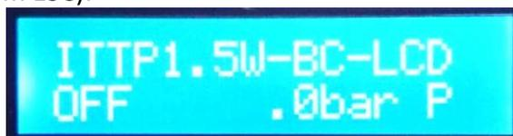
3. Spustíme samoregulačný test stlačením tlačidla START. Čerpadlo sa ešte nespustí, ale na displeji sa objaví nastavovacie menu základných parametrov motora:
